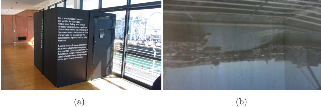
Slika 3.1: (a) Camera obscura v človeški velikosti postavljena v pristanišču mesta Cape Town in (b) posnetek slike, ki je nastala na stenah znotraj naprave.
